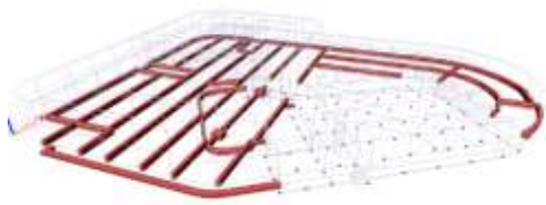
Overzicht modellering fundering - bestaande situatie
